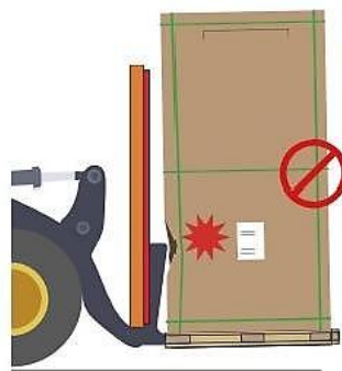
图7 禁止货叉的凸起部分直接与纸箱接触
